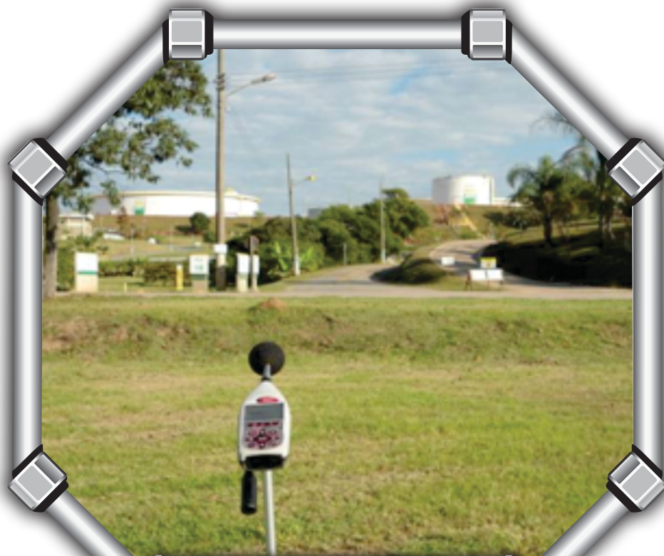
Aparelho utilizado para medir o nível de ruído na área de influência do empreendimento. Fonte: Bourscheid (2013)
